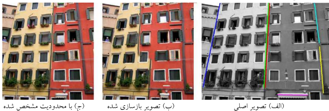
شکل ۵. ۴ - محدودیت‌های مدل. (الف) تصویر اصلی (ب) بدون محدودیت، با ایجاد مرزهای شکسته بازسازی شده است. (ج) زمانیکه محدودیت‌های نشان داده شده به صورت خطوط رنگی اضافه شده اند، مرزها راست باقی مانده اند.
