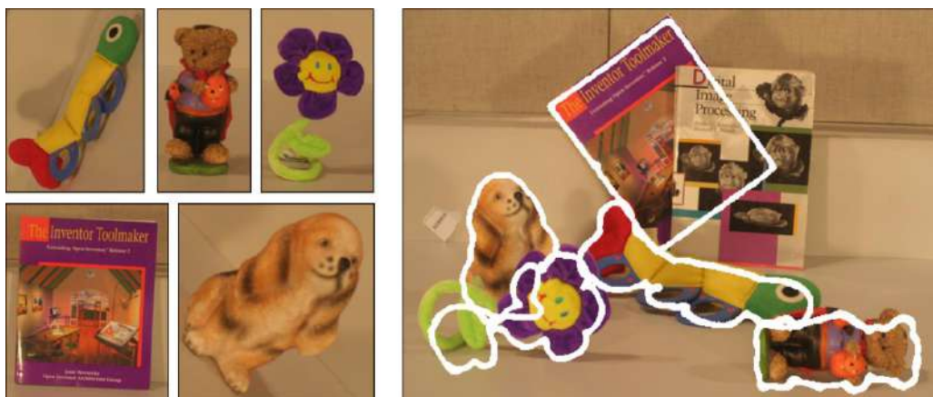
شکل ۴.۷ - تشخیص اشیا. الگوهای چپ، با تصویر، راست، تطابق دارند. patchهای مربعی، جستجو در تمام چرخشها و مقیاسها همانطور که در بخش ۳.۵ توصیف شده تطابق یافته اند. یک انتقال مشابه با تناظرهای حاصل با RANSAC تطابق یافته است.
